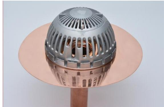
La crépine et le collet de serrage s'installent et s'enlèvent facilement, car ils sont tout simplement fixés au drain avec l'aide de 6 écrous hexagonaux. Le couvercle de la crépine est retenu en place par 2 rivets et une vis assurant ainsi un assemblage complet **anti-vandalisme**.
