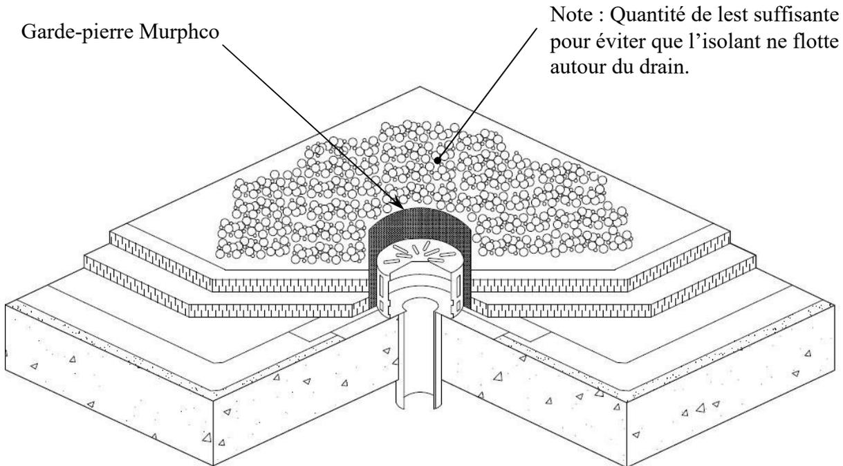
Le **Garde-pierre Murphco** est conçu pour les toitures plates à système inversé (membrane protégée) et est compatible avec toutes les variétés de membrane.
